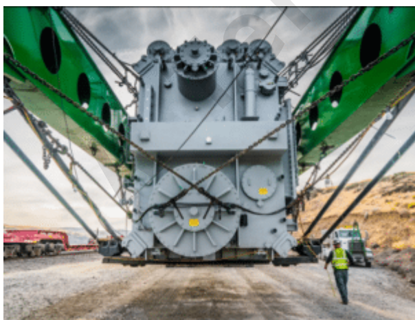
Figura 11: Movendo um grande transformador de potência de 210 toneladas. O peso combinado do transformador e do equipamento necessário para movê-lo é de 430 toneladas. [37] Os LPTs não podem ser instalados rapidamente, mesmo depois que seus substitutos tiverem sido fabricados e entregues aos EUA.
